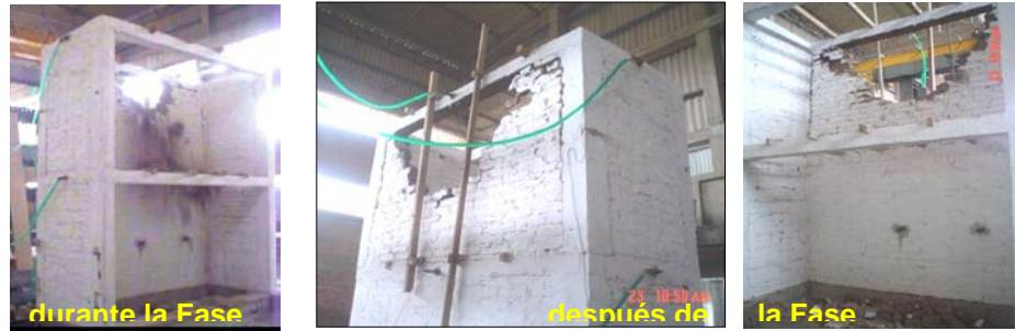
Fig.11 Fase 4. Muros de Flexión y de Corte.
