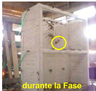
Fig.10. Fase 3. Colapso de un adobe del Piso 2.
