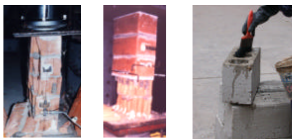
Fig. 1. Fallas frágiles en unidades con más de 30% de huecos (izq, centro) y bloques de concreto artesanales usados en Tacna (der.)
