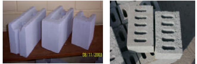
Fig. 9. Unidades apilables (bloques) sílico calcáreas (izq., fuente C. Casabonne), y ladrillos de concreto (der.) cuyas propiedades aún no están en la Norma.
