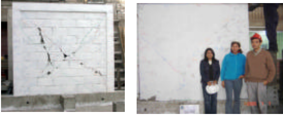
Fig. 7. Muro hecho de bloques de concreto artesanal: falla del muro original (izq.) y falla del muro reforzado con malla electrosoldada (der.) Quiun, Alférez y Quinto (2005)
