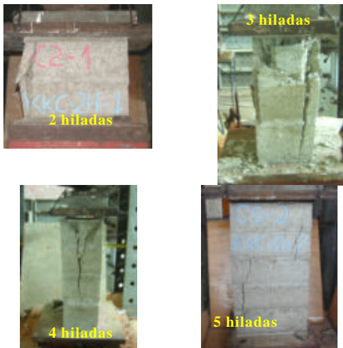
Fig.14. Pilas de ladrillo de concreto KKC.
