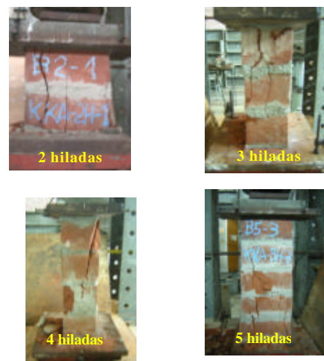
Fig.12. Pilas de ladrillo artesanal KKA.
