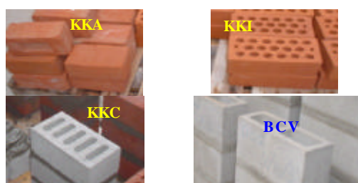
Fig.2. Unidades de albañilería utilizadas: King Kong Artesanal de arcilla (KKA); 2) King Kong Industrial de arcilla (KKI); 3) King Kong industrial de Concreto (KKC); y, 4) Bloque de Concreto Vibrado (BCV).
