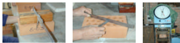
Fig.3. Ensayos de la unidad de albañilería. De izquierda a derecha: Variación de Dimensiones, Alabeo y Compresión.
